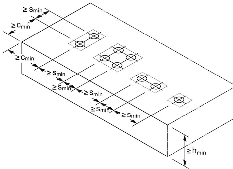
Für den Einbau der Anker in der Stirnseite eines Bauteils gelten die Achs- und Randabstände sowie Mindestbauteildicken sinngemäß
