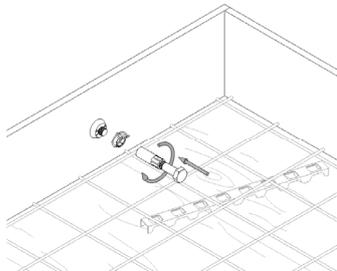
3. Falls erforderlich, Zusatzbewehrung mittels PHILIPP Kennzeichnungsring an der Hülse befestigen.
