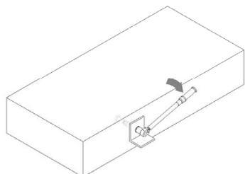
Maximale Montagedrehmomente max.  $T_{inst}$  für PB Anker
