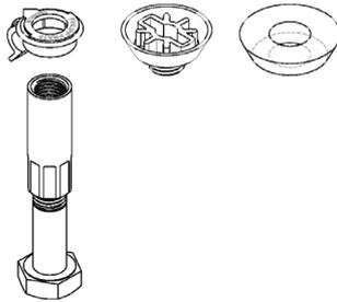
1. PHILIPP PB Anker mit Hülse aus galvanisch verzinktem oder nichtrostendem Stahl
